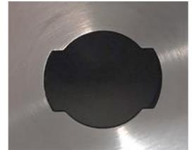
L'axe d'entraînement des accessoires peut être enlevé du fond du bol inox en tournant l'écrou de verrouillage en sens inverse des aiguilles d'une montre (*notamment dans le cadre du nettoyage du bol inox et des accessoires*)
