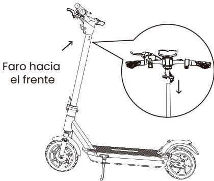
3. Instala seis tornillos (dos a cada lado) con la llave hexagonal incluida.
