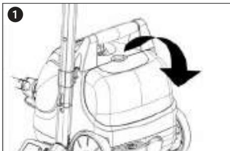
Neem het vereiste accessoire-onderdeel eruit, en sluit de afdekking. Duw de grendel van de afdekking in de uitsparing, en druk deze vast naar onderen, tot deze vastklikt.
