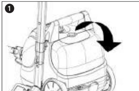
Retirer l'accessoire correspondant et fermer le recouvrement. Glisser le verrou du dispositif de recouvrement dans la fente et l'enfoncer vers le bas jusqu'à ce qu'il s'enclenche.
