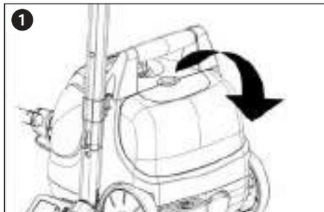
Выньте требуемую принадлежность и закройте крышку. Сместите фиксатор крышки в вырез и крепко прижмите его вниз так, чтобы он зафиксировался.
