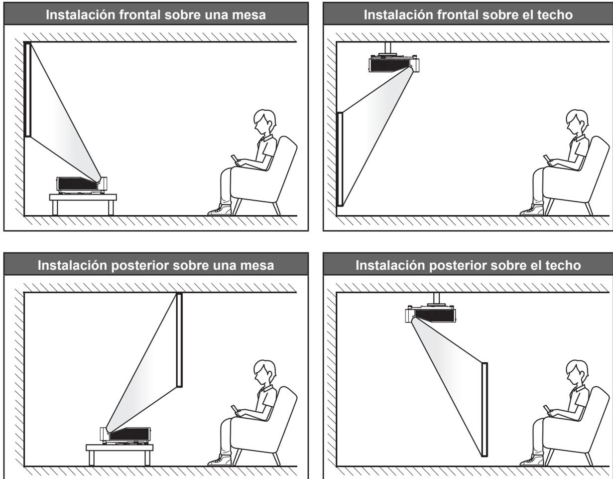
El proyector se debe colocar plano sobre una superficie y con un ángulo de 90 grados o perpendicular a la pantalla.
