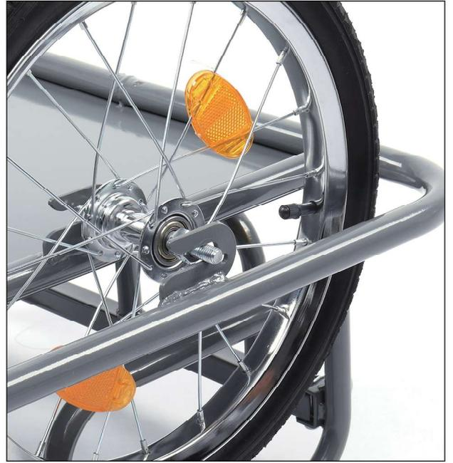
6-inserez l'axe des roues dans les fentes prévues.
