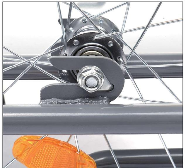
7- Insérez le crochet et resserrez l'écrou.
