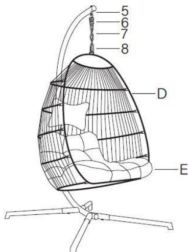
**Schritt 4:** Setze die Federaufnahme (**5**), Feder (**6**) und die Kette (**7**) und Karabinerhaken (**8**) ein, um den Korb aufzuhängen.
