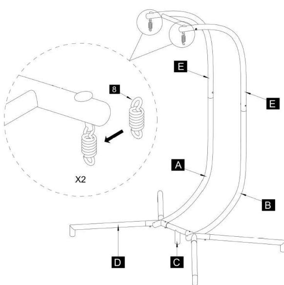
**Schritt 6:** Befestige die Feder (8) in der Federaufnahme.
