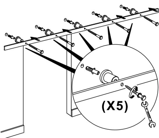
**Schritt 6b: Laufschiene an die Wand schrauben**
