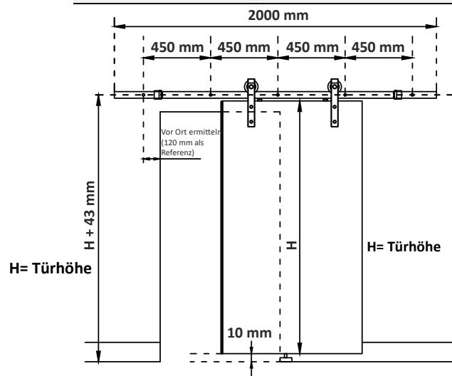
**Aufbauschritt****Schritt 5: Übersichtskizze mit Montagemaße**
