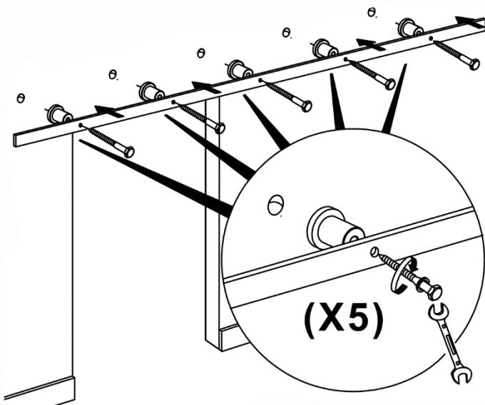
**Aufbauschritt****Schritt 8b: Laufschiene an die Wand schrauben**
