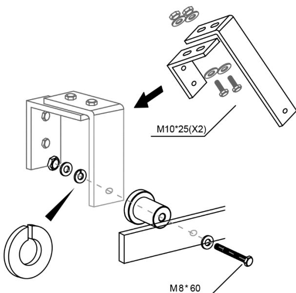
**Schritt 9a: Winkelverbinder montieren**
