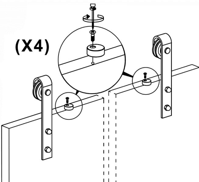
**Aufbauschritt****Schritt 11: Absturzsicherung montieren**
