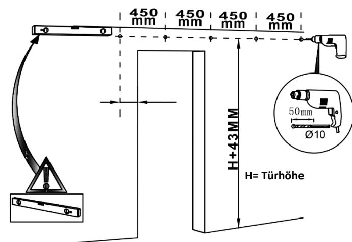
**Aufbauschritt****Schritt 6a: Wand vorbohren**
