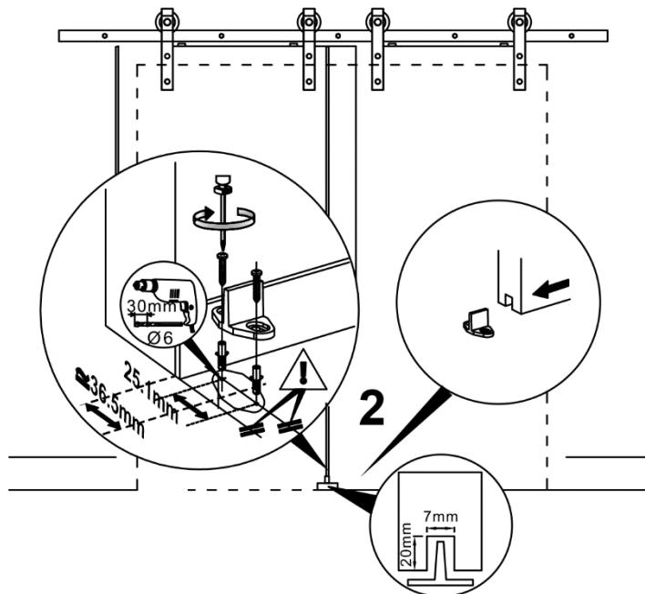
**Aufbauschritt****Schritt 13: Bodenführung montieren**
