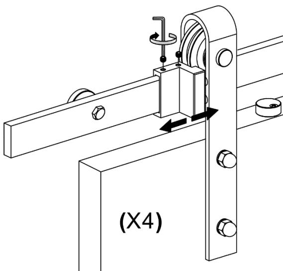
**Schritt 16: Türanschlag montieren**
