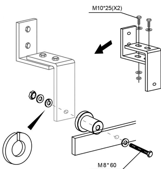
**Aufbauschritt****Schritt 7a: Winkelverbinder montieren**
