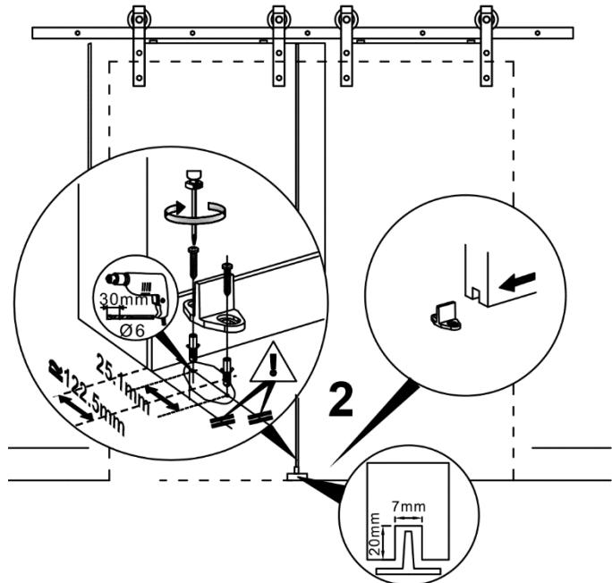
**Aufbauschritt****Schritt 15: Bodenführung montieren**
