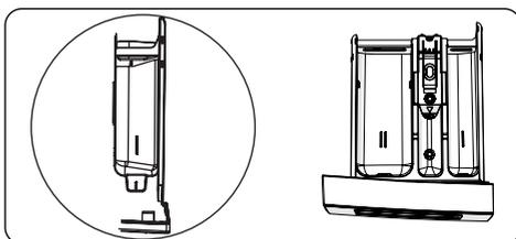
Utiliser uniquement ce compartiment lorsque la fonction Pré-lavage a été sélectionnée. Il est conseillé de sélectionner cette fonction avec du linge très souillé uniquement.
