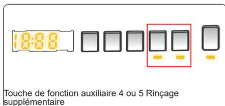
Cette fonction permet d'ajouter un cycle de rinçage supplémentaire à la fin du programme de lavage sélectionné.
