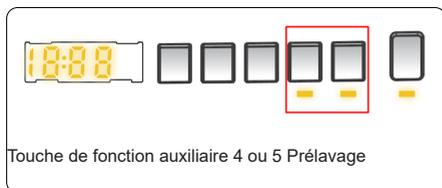
Pour un linge très souillé, cette fonction permet d'initier un cycle de prélavage avant le démarrage du programme de lavage principal. L'utilisation de cette fonction nécessite d'ajouter de la lessive dans le compartiment prélavage du tiroir à produits lessiviels.
