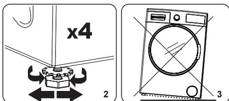
2. Pour augmenter la hauteur de la machine, tourner les pieds dans le sens horaire. Pour réduire la hauteur de la machine, tourner les pieds dans le sens antihoraire.
