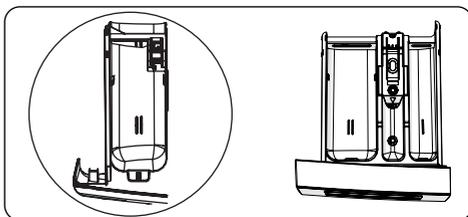
Ce compartiment est destiné aux lessives liquides ou en poudre ou aux produits anticalcaire. La règle graduée (en option) pour lessive liquide est livrée à l'intérieur de la machine. (\*)
