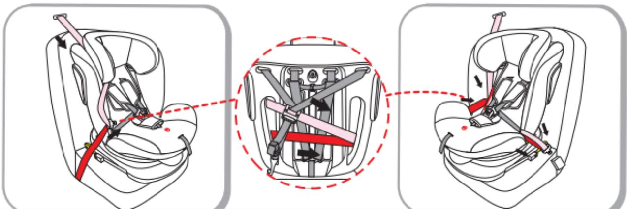
Étape 6: Insérez la ceinture diagonale et dans la boucle du véhicule.
