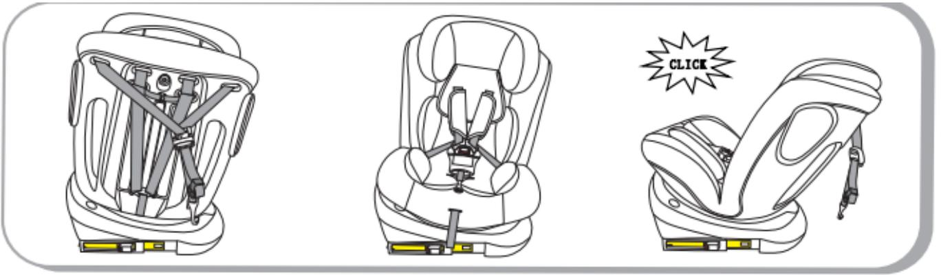
**IMPORTANT :** Assurez-vous que le siège auto est correctement verrouillé dans la direction souhaitée. En tournant le siège-auto dans le sens et/ou sens contraire des aiguilles d'une montre, vous entendrez alors un « clic » qui vous permettra de savoir que le siège auto est correctement verrouillé.
