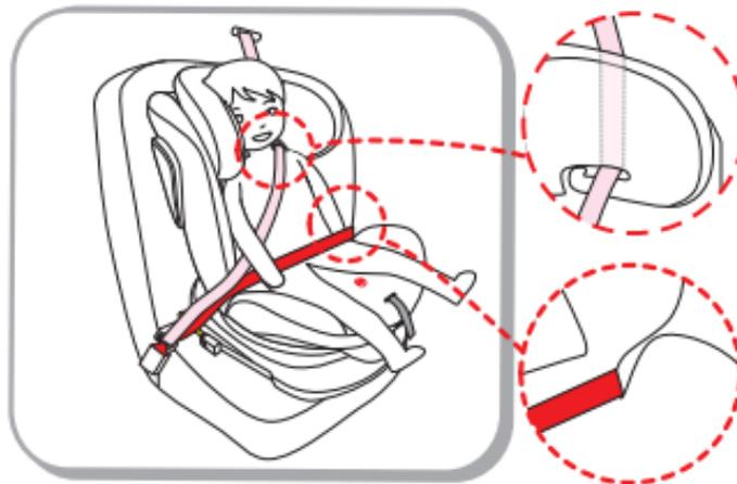
Étape 6: Insérez la ceinture dans la boucle du véhicule. Vérifiez que la boucle de ceinture du véhicule est correctement verrouillée.
