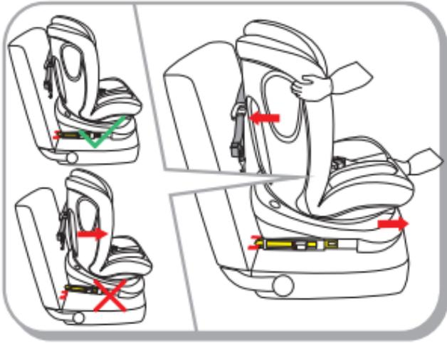
Étape 3: Saisissez le corps et la base du siège pour vérifier si le siège est correctement fixé.. Si le siège n'est pas fixé et que les connecteurs ISOFIX sont retirés, veuillez répéter les étapes ci-dessus et réinstaller. Relâchez la poignée d'inclinaison une fois qu'elle est engagée dans la direction souhaitée
