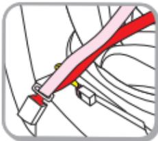
Assurez-vous que la ceinture de sécurité ne soit pas tordue. Vérifiez également que la housse du siège-auto n'entrave en aucune façon le mouvement ou l'ajustement de la sangle de la ceinture de sécurité.
