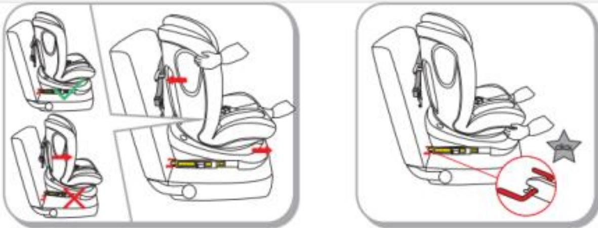
Étape 4: Appuyez sur la poignée de rotation et faites pivoter le siège. Relâchez la poignée de rotation et tournez jusqu'à entendre un "clac".
