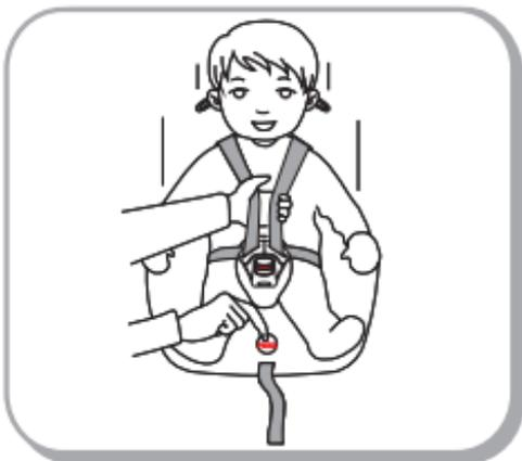
Le harnais se détend en appuyant sur le dispositif de réglage (sous la housse du siège) situé à l'avant du siège.
