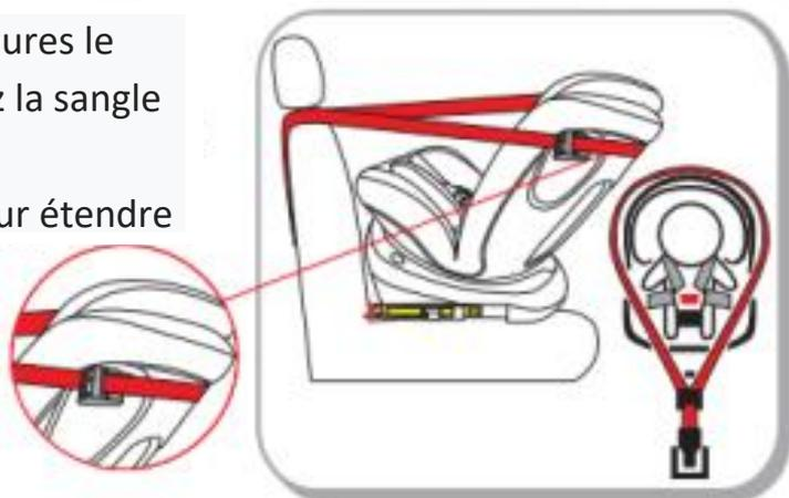
Étape 6: Accrochez le crochet de la sangle d'attache dans les ancrages.
