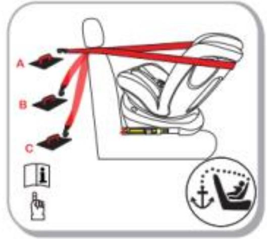
Étape 7: Tirez la sangle à une autre extrémité pour resserrer l'attache supérieure.
