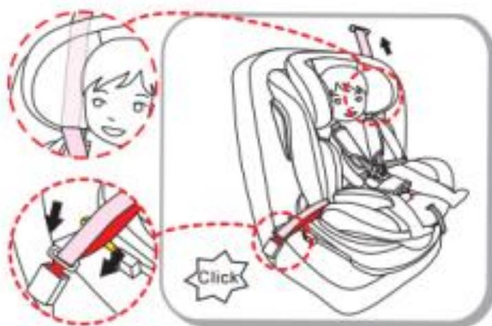
Étape 7: Vérifiez que la ceinture de la voiture et le harnais de sécurité ne soient pas emmêlés et vérifiez également que cela n'entrave en aucun cas le mouvement.
