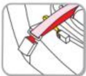
Assurez-vous que la ceinture de sécurité n'est pas tordue. Vérifiez également que la housse n'entrave en aucun cas le mouvement ou l'ajustement de la sangle de la ceinture de sécurité.
