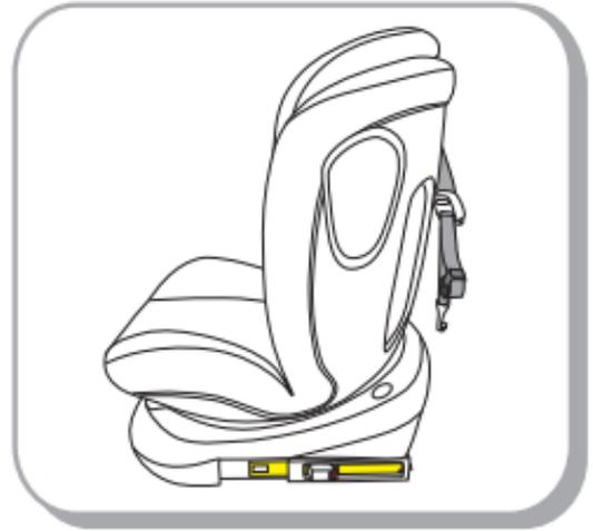
Étape 2: placez le siège enfant sur le siège d'auto orienté vers l'avant et appuyez sur le bouton de déverrouillage ISOFIX des deux côtés du siège et poussez les connecteurs ISOFIX vers l'avant et faites en sorte que les connecteurs ISOFIX soient complètement étendus. Cela garantit que les deux crochets des connecteurs ISOFIX s'étendent complètement. Cela garantit que les deux crochets des connecteurs ISOFIX sont ouverts prêts à l'emploi, maintenant
