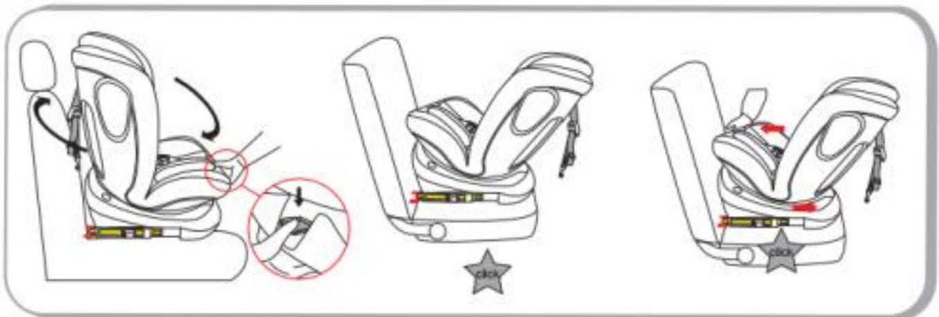
Étape 5: Faites glisser les sangles supérieures le long des deux côtés de l'appui-tête. Tirez la sangle supérieure et appuyez sur le bouton de déverrouillage de la sangle d'ancrage pour étendre
