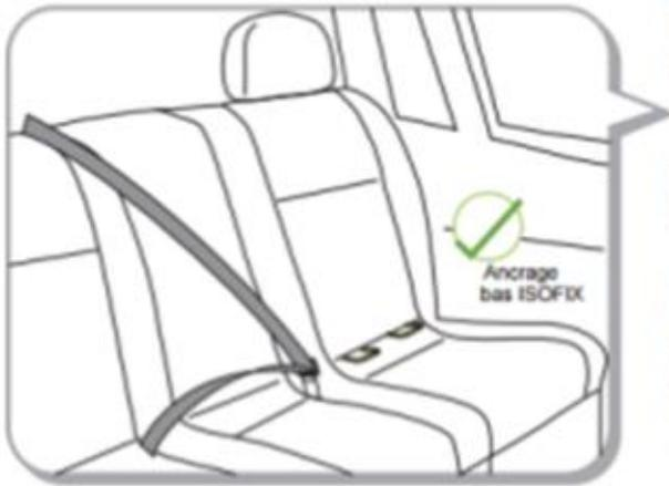
Ce siège auto est adapté pour être installé avec les ancrages ISOFIX de votre voiture conformes à la norme Européenne en vigueur.
