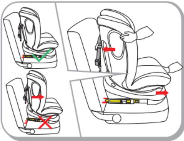
Étape 4: Saisissez le corps et la base du siège pour vérifier si le siège est correctement fixé. Si le siège tremble et que les connecteurs ISOFIX sont retirés, veuillez répéter les étapes ci-dessus et réinstaller.
