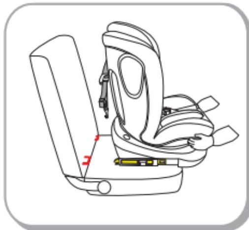
Étape 3: Saisissez le corps et la base du siège pour vérifier si le siège est correctement fixé.. Si le siège n'est pas fixé et que les connecteurs ISOFIX sont retirés, veuillez répéter les étapes ci-dessus et réinstaller. Relâchez la poignée d'inclinaison une fois qu'elle est engagée dans la direction souhaitée jusqu'à ce que vous entendiez un "clic"
