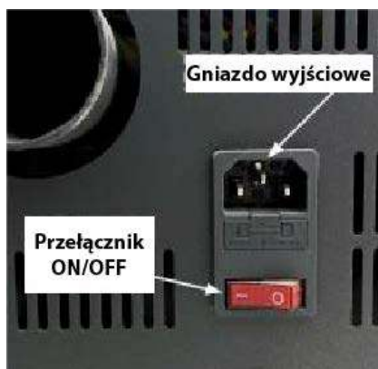
Złącze zasilania + przełącznik ON/OFF
