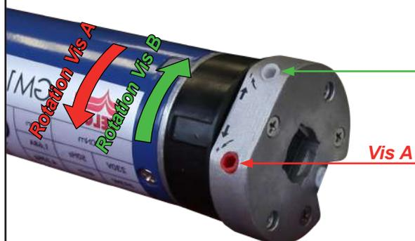
**Fin de course :** Actionner la vis vers le «+» pour plus de fermeture ou d'ouverture, vers le «-» pour moins fermeture ou d'ouverture.
