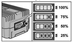
Die Anzeige erlischt nach 5 Sekunden. Blinkt eine der LED, muss der Akku geladen werden. Wenn nach dem Drücken der Taste keine LED leuchtet, ist der Akku defekt und muss ersetzt werden.
