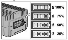
Le voyant s'éteint au bout de 5 secondes. Si l'une des LED clignote, l'accumulateur doit être rechargé. Si, après avoir appuvé sur le bouton, aucune LED ne s'allume, l'accumulateur est défectueux et doit être remplacé.
