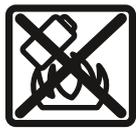
**Proteja la batería del calor excesivo, además de, p. ej., una exposición prolongada al sol, la suciedad, el fuego, el agua o la humedad.** Existe riesgo de explosión y cortocircuito.
