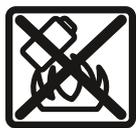
**Proteggere la batteria dal calore, ad esempio anche da irradiazione solare continua, fuoco, sporcizia, acqua ed umidità.** Sussiste il pericolo di esplosioni e cortocircuito.
