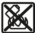
**Beskyt akkuen mod varme (f.eks. også mod varige solstråler, brand, snavs, vand og fugtighed).** Der er risiko for eksplosion og kortslutning.
