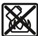
**Skydda batteriet mot hög värme som t. ex. längre solbestrålning, eld, smuts, vatten och fukt.** Explosions- och kortslutningsrisk.
