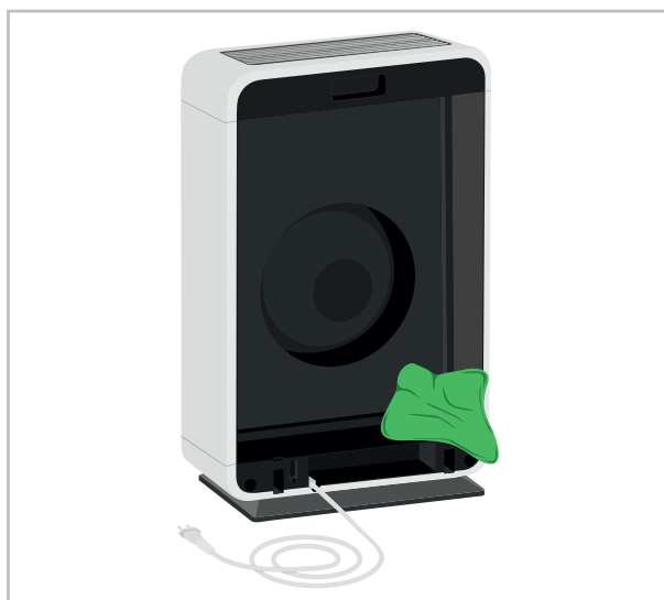
Fig. 17: Nettoyage du boîtier de filtration
