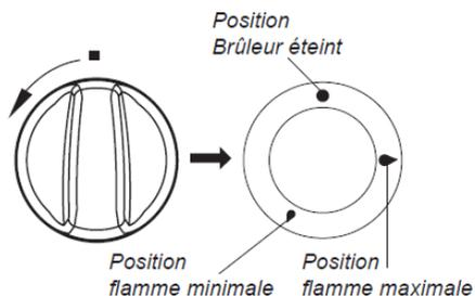
**NOTE :** Cette table de cuisson est équipée d'un thermocouple sur les brûleurs, le bouton doit être enfoncé en position « flamme maximale » pendant l'allumage durant environ 3 secondes pour que le dispositif se mette en marche.
