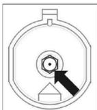
Changement de l'injecteur du brûleur de la plaque de cuisson – dévisser l'injecteur à l'aide d'une clé d'un diamètre 7 et le remplacer par un injecteur adapté à la famille de gaz (voir tableau de correspondance)
