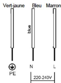
Utilisez un branchement comportant une borne de mise à la terre, qui doit être obligatoirement être raccordée conformément à la norme NF C 15-100.
