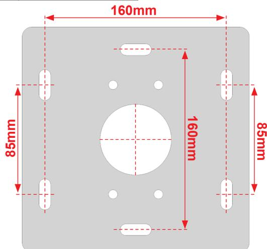
Fixer les platines au niveau de chaque plots béton réalisés au-paravant par deux vis minimum.
