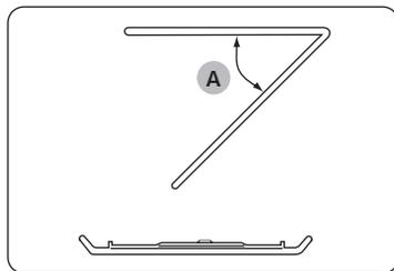
Pour nettoyer la zone supérieure du compartiment de cuisson, abaissez l'élément chauffant supérieur de 45° (A), comme indiqué. Cela permettra de nettoyer la zone supérieure. Une fois cela fait, repositionnez l'élément chauffant supérieur.
