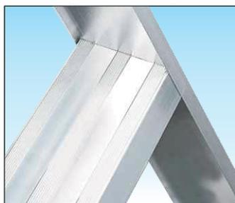
Marches profondes mm 83 très solide soudées sur épaisseurs majorées. Unie au montant vertical par une solide soudure à angle cachée, garantit le maximum de stabilité et de longue durée.
