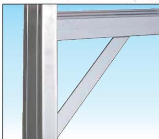
Marches renforcées avec nervures en aluminium antirouille soudé. Nervures en solide profil plat en aluminium soudé, large 20mm épais 3mm, elles renforcent chaque marche contre les chocs et chargements trop lourds.
