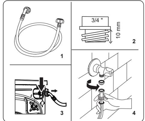
1. En fonction de ses caractéristiques techniques, votre machine peut être équipée soit d'un seul et unique raccord de tuyau d'arrivée d'eau (eau froide), soit d'un raccord double (eau chaude et eau froide). Le tuyau à bouchon blanc doit être raccordé à l'arrivée d'eau froide et celui à bouchon rouge à l'arrivée d'eau chaude (le cas échéant).
