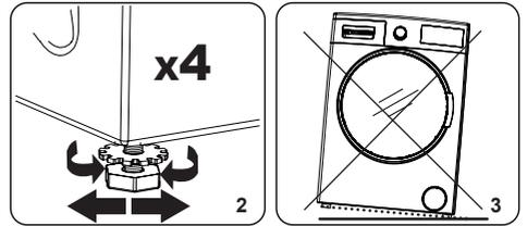
2. Pour augmenter la hauteur de la machine, tourner les pieds dans le sens horaire. Pour réduire la hauteur de la machine, tourner les pieds dans le sens antihoraire.
