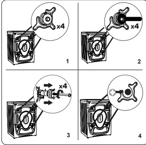
1. Avant d'utiliser le lave-linge, retirer les 4 vis de bridage et rondelles en caoutchouc situées à l'arrière de la machine. Le non-respect de cette consigne peut causer de fortes vibrations, un niveau de bruit important et détériorer de la machine et rendre la garantie caduque.
