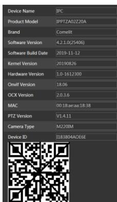
Certaines versions peuvent prendre en charge l'ID de l'appareil et le code QR. Si P2P est activé (voir Configuration réseau-P2P), la caméra réseau peut être rapidement ajoutée au client de surveillance mobile, en scannant le code QR ou en entrant l'ID de l'appareil.
