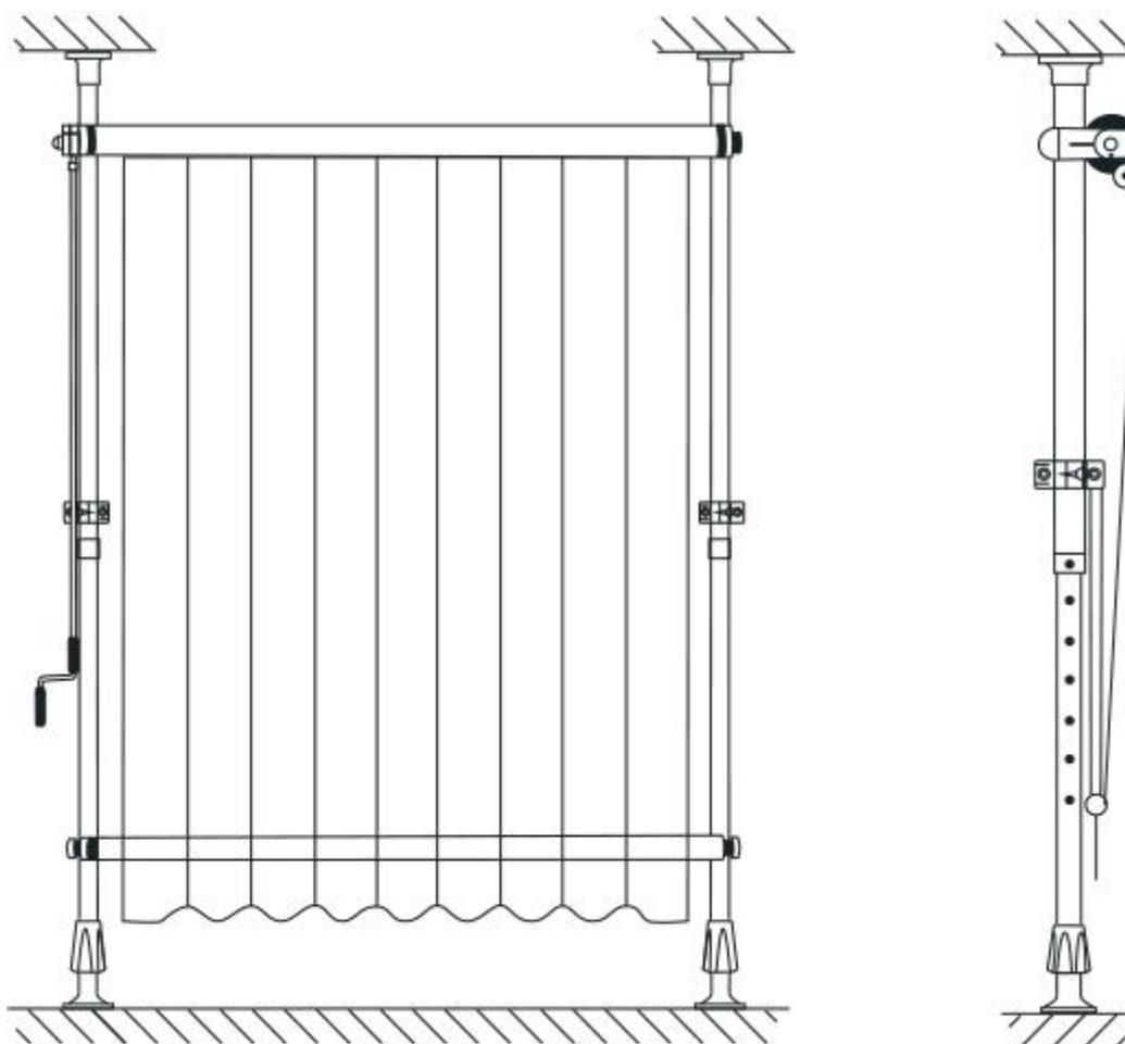
**ATTENTION !!!** Veuillez à ce que la toile du store soit toujours entièrement rentrée afin d'empêcher que le store ne se déroule en raison d'une force extérieure comme le vent par exemple. Le treuil n'est pas équipé d'un dispositif de blocage.
