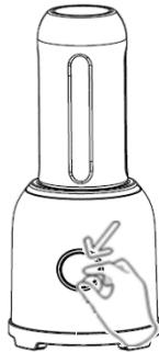
*Hinweis: Die Einschaltzeit des Gerätes von einer Minute darf nicht überschritten werden. Lassen Sie das Gerät jedes Mal, nachdem es eine Minute lang in Betrieb war, mindestens fünf Minuten abkühlen. Dieser Vorgang kann dreimal wiederholt werden. Lassen Sie das Gerät anschließend auf Raumtemperatur abkühlen, bevor Sie es erneut verwenden.*
