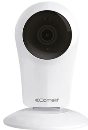
WICCAMS02FA est une caméra IP Wi-Fi dédiée aux systèmes Secur Hub et à la vidéophonie. Double flux RTSP, résolution maximale Full-HD, 10 images/seconde et compression H.264, déjà réglée pour l'intégration avec la centrale d'alarme Secur Hub ou avec le système de vidéophonie. Alimentation et étrier pivotant de table/en saillie compris.
