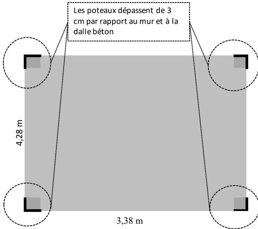
Ce schéma présente l'emprise au sol de l'abri de jardin. Ce sont donc les dimensions plancher. Sur la partie fermée, il y a 3 cm de chaque côté en plus par rapport aux dimensions affichés. Ces 3 cm correspondent aux poteaux qui dépassent de la dalle. L'objectif est que les murs arrivent à la limite de la dalle béton.
