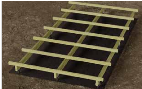
Exemple pour structure croisée en bois avec solives 45 x 145 mm et lambourdes 45 x 70 mm
