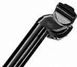
La selle est fixée à une attache de la tige de selle, généralement à l'aide d'une vis Allen M8 et d'une clé Allen de 6 (20nm).
