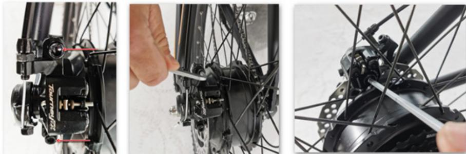
L'extérieur de la plaquette de frein peut être maintenant ajusté à l'aide du câble Bowden.
