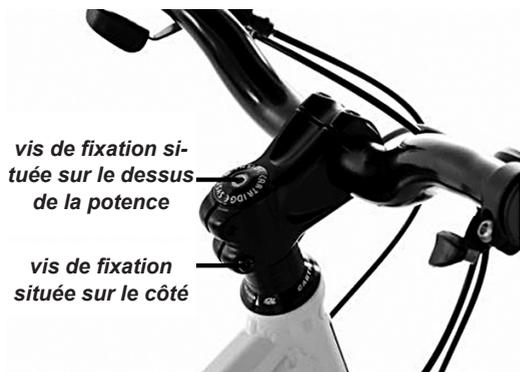
Les potences Ahead sont fixées à l'aide d'une ou de deux vis situées sur le côté du pivot de fourche.
