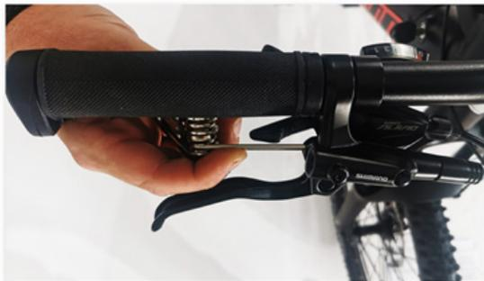
Si le point de contact est trop faible ou l'écart avec le disque de frein trop important, le point de contact peut être ajusté au niveau du levier de frein.
