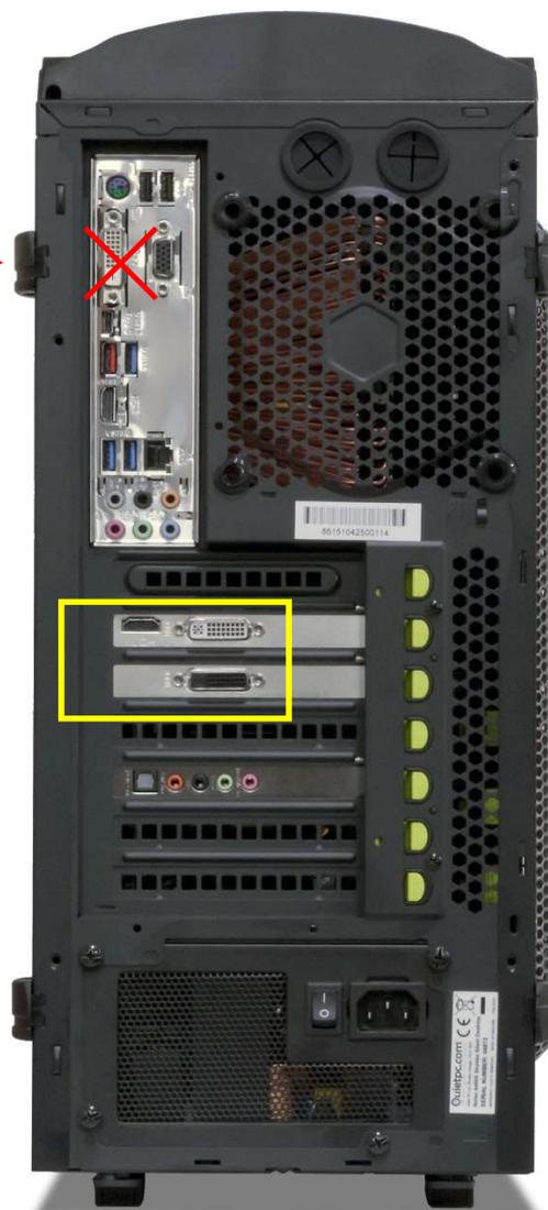
Si usted ya conectó por error en la gráfica de arriba (integrada) en lugar de la gráfica dedicada, deberá apagar el PC conectar correctamente y volver a encender (no basta con cambiar el cable mientras esté encendido).
