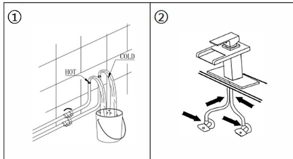
1. Avant l'installation, veuillez ouvrir la vanne triangulaire et la première vidange, videz soigneusement les eaux usées et les impuretés dans la canalisation, afin d'éviter de bloquer le robinet et d'affecter son utilisation normale (Fig.1).
