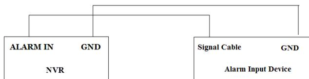
Si l'entrée n'est pas un relais ouvert/fermé, se reporter au schéma de connexion suivant :
