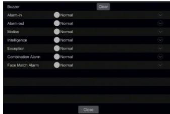
Cliquer sur « Clear''' (Effacer) pour arrêter le buzzer quand une alarme de buzzer se produit. Cliquer sur
