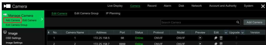
Il y a quelques éléments de fonction sur le côté gauche de l'interface Manage Camera (Gestion de la caméra). Cliquer sur chaque élément pour accéder à l'interface ou à la fenêtre correspondante. Par exemple, cliquer sur « Add Camera » (Ajouter caméra) pour faire apparaître la fenêtre telle que montrée ci-dessous.
