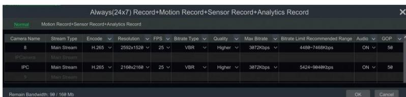
**Video Encode** (codage vidéo) : H.265 ou H.264 si la caméra IP connectée prend en charge H.265 ; sinon, l'option sera H.264 uniquement.
