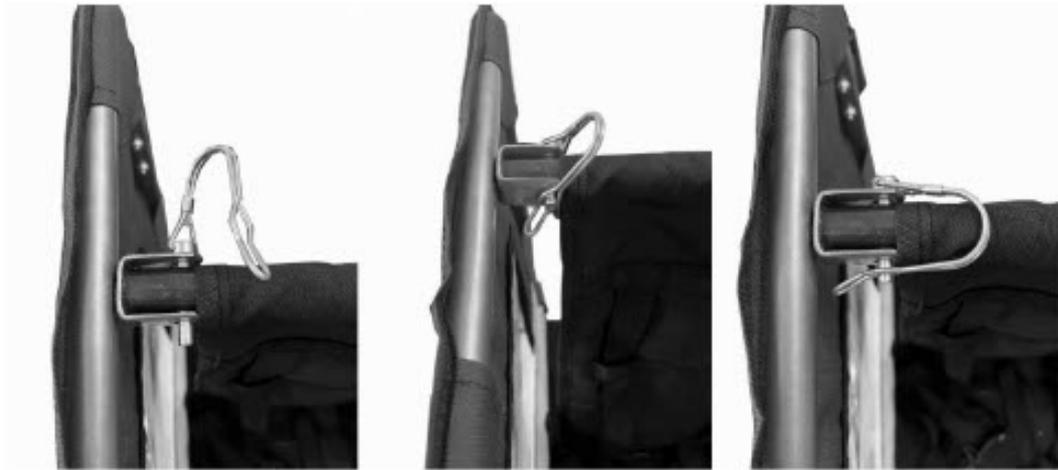
C) Monter le couvercle (toit de la remorque), fixer la cloison à l'arrière de la remorque de manière à créer un compartiment pour les petits objets.
