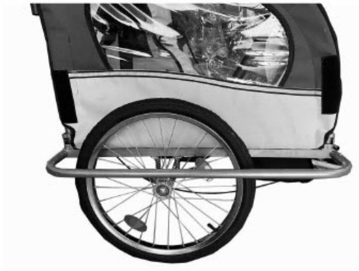
Rails zijn een extra bescherming tegen het uitschuiven van het wiel, de Installatie hiervan is noodzakelijk!
