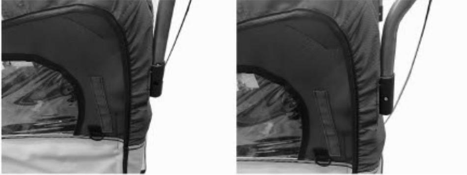
i) Vissez le support sur le cadre du vélo sous la fixation de la roue arrière (sur le côté gauche de la remorque, comme indiqué sur les images ci-dessous). Assurez-vous que la remorque est bien reliée à la poignée et que les sangles de sécurité sont bien attachées afin que, même dans les situations extrêmes, la sangle reste attachée.
