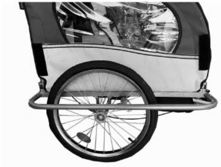
Les rails sont une protection supplémentaire contre le glissement de la roue, leur installation est nécessaire!
