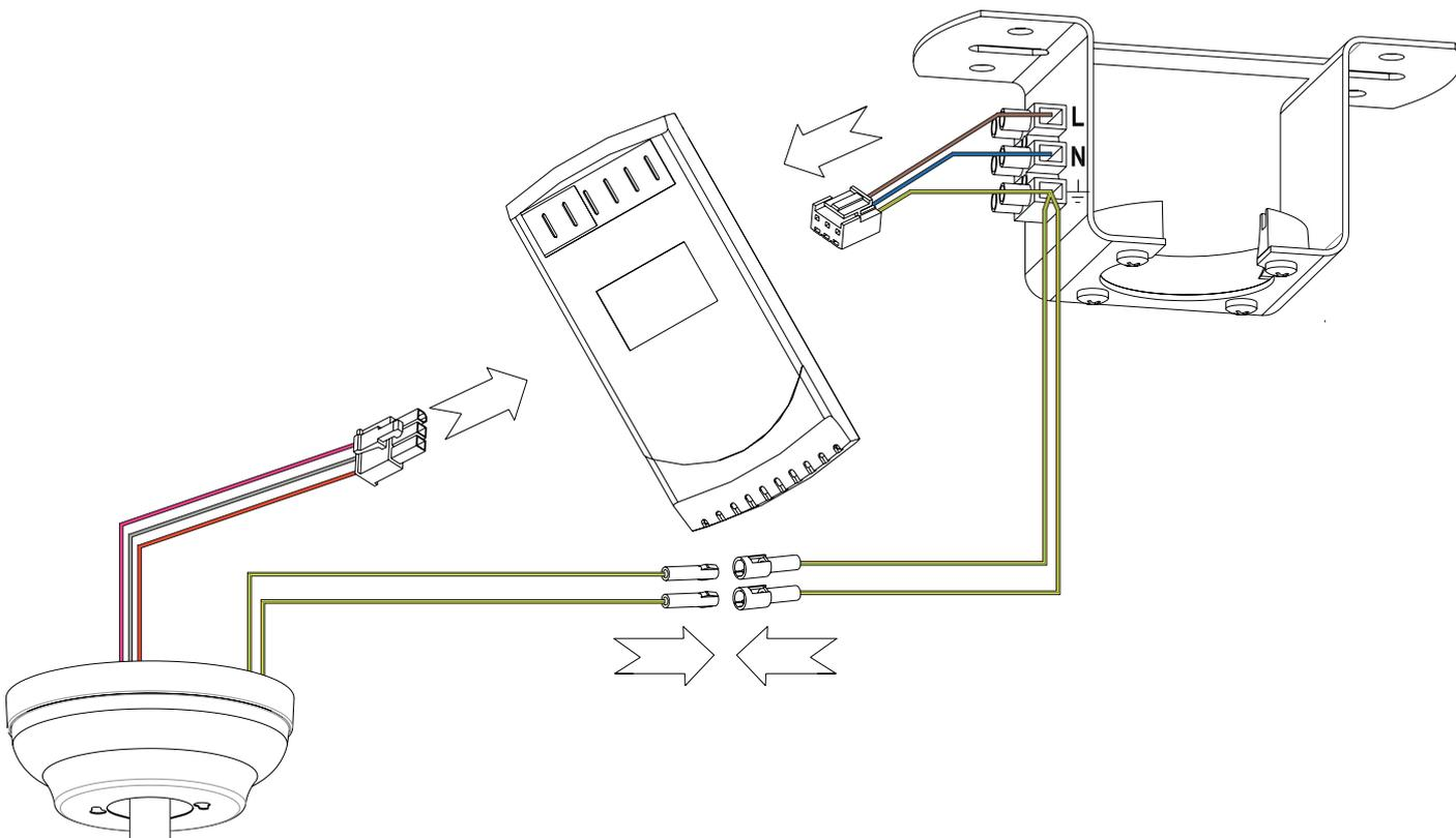
Vérifiez que les connexions ont bien été effectuées et que le récepteur et les fils sont correctement rangés dans le support.
