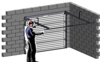
① Desserrer les vis latérales du support haut et régler sa hauteur pour que le panneau vienne en contact avec le joint de la traverse haute sans trop l'écraser.
