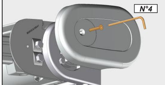
Les coudes de bras doivent être centrés dans la barre de charge. Aucun contact entre les deux éléments.
