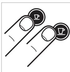
5. Aby włączyć tryb odkamieniania należy w stanie gotowości wcisnąć jednocześnie przyciski Espresso i Lungo na 3 sekundy.
