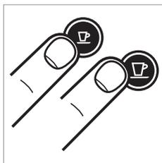
1. U schakelt de leegmodus in door de knoppen Espresso en Lungo tegelijk in te drukken, zodat de machine wordt uitgeschakeld.
