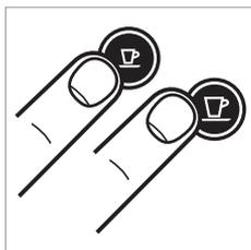
1. Aby wejść w tryb opróżniania, należy wcisnąć przyciski Espresso i Lungo jednocześnie, w celu wyłączenia maszyny.
