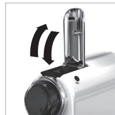
6. Usunąć filiżankę. Podnieść i zamknąć dźwignię w celu odrzucenia kapsułki do pojemnika na zużyte kapsułki.
