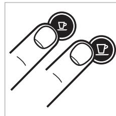
Aby wyłączyć urządzenie, zanim wejdzie w stan czuwania, należy przycisnąć jednocześnie przycisk Espresso i Lungo.
