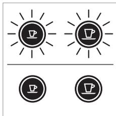
3. De indicatielampjes knipperen vervolgens normaal, net als bij het opwarmen, totdat de machine klaar is voor gebruik.
