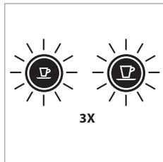
2. Oba przyciski zamigają szybko, trzykrotnie - urządzenie wróci do ustawień fabrycznych.
