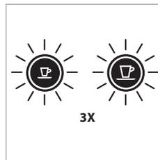
2. De indicatielampjes knipperen drie keer snel om te bevestigen dat de fabrieksinstellingen op de machine zijn hersteld.
