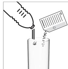
3. Vul het waterreservoir met 0,5 L drinkwater en voeg een zakje Nespresso ontkalkingsmiddel toe.
