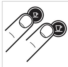
10. Aby wyjść z trybu odkamieniania, wcisnąć jednocześnie i przytrzymać przez 3 sekundy przyciski Espresso i Lungo.
