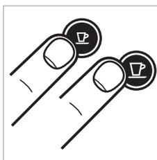
5. U start de ontkalkingsmodus in door de knoppen Espresso en Lungo, terwijl de machine is ingeschakeld, 3 seconden lang tegelijk in te drukken.
