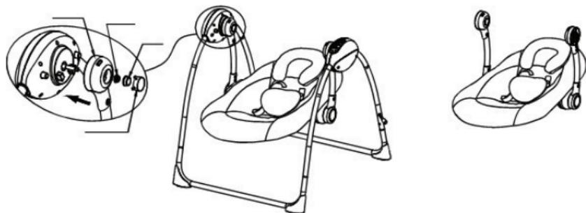
4. Placez les deux extrémités de l'assise dans des trous carrés sur les bras gauche et droit du siège, comme indiqué dans l'image ci-dessous.
