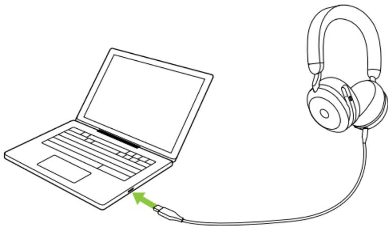
Se tarda aproximadamente 2 horas y 40 minutos en cargar completamente la batería. La duración de la batería del auricular es de hasta 36 horas. Si el auricular no tiene batería, puede cargarlo durante 15 minutos y obtendrá 6 horas de autonomía.
