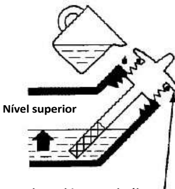
Tampa de enchimento de óleo
