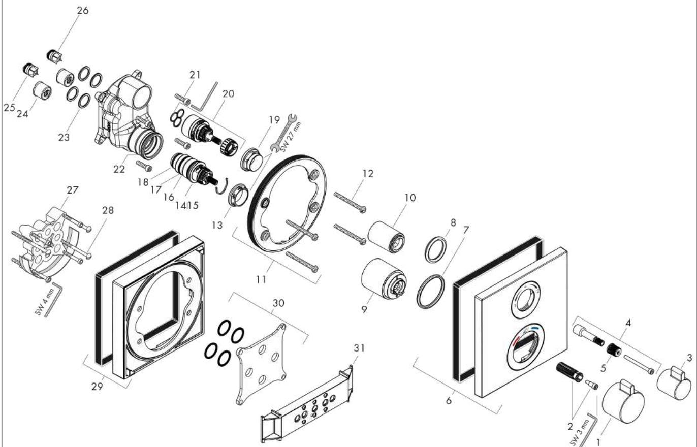
**Ecostat Square****Set de finition pour mitigeur thermostatique encastré avec robinet d'arrêt et inverseur**Surfaces: **chromé** Numéro d'article: **15714000**
