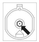
Changement de l'injecteur du brûleur de la plaque de cuisson – dévisser l'injecteur à l'aide d'une clé d'un diamètre 7 et le remplacer par un injecteur adapté à la famille de gaz (voir tableau de correspondance)
