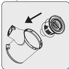
Fixez le filtre en plastique sur le réservoir à poussière (5).
