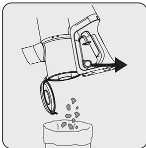
Tirez l'anneau d'ouverture du réservoir à poussière (4) jusqu'au dernier niveau. Le couvercle du réservoir à poussière s'ouvre. Videz toute la poussière qu'il contient.
