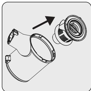
Retirez le filtre EPA E10 et le filtre en plastique en tenant la poignée du filtre EPA E10
