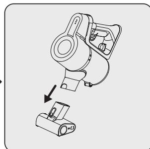
**Mini Turbo brosse (14) :** Convient pour le nettoyage des sols, des marches d'escalier, de l'intérieur des voitures, des canapés et des sièges, etc. Elle est également utilisée pour nettoyer les poils d'animaux sur ces surfaces.
