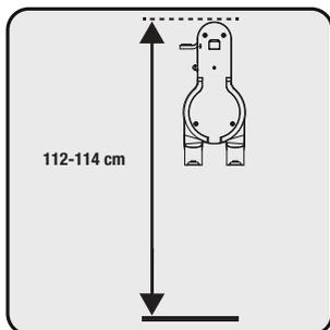
Positionnez la station de charge (8) à une hauteur de 112 à 114 cm du sol.
