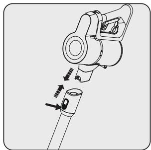
Poussez le tube (10) dans le sens de la flèche vers le corps en appuyant sur le bouton de déverrouillage du tube (6).
