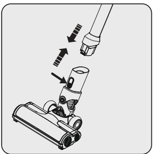
Appuyez sur le bouton de déverrouillage de la brosse turbo électrique (11) situé sur la brosse turbo électrique (12), ensuite poussez-la dans le sens de la flèche vers le tube.
