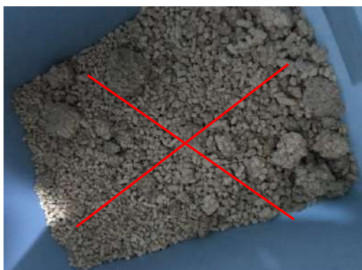
Agglomerazione di pellet di scarsa qualità
