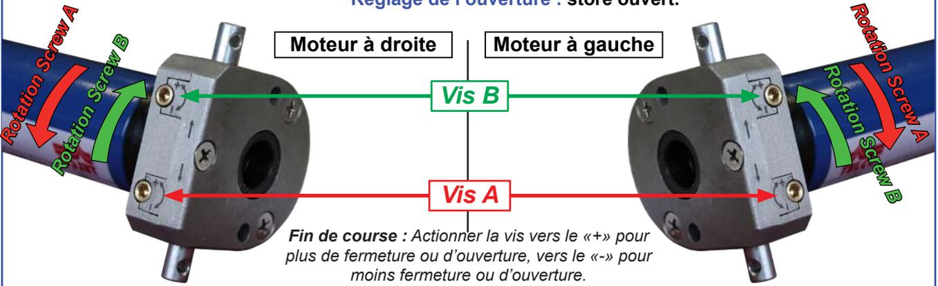
**Fin de course :** Actionner la vis vers le «+» pour plus de fermeture ou d'ouverture, vers le «-» pour moins fermeture ou d'ouverture.
