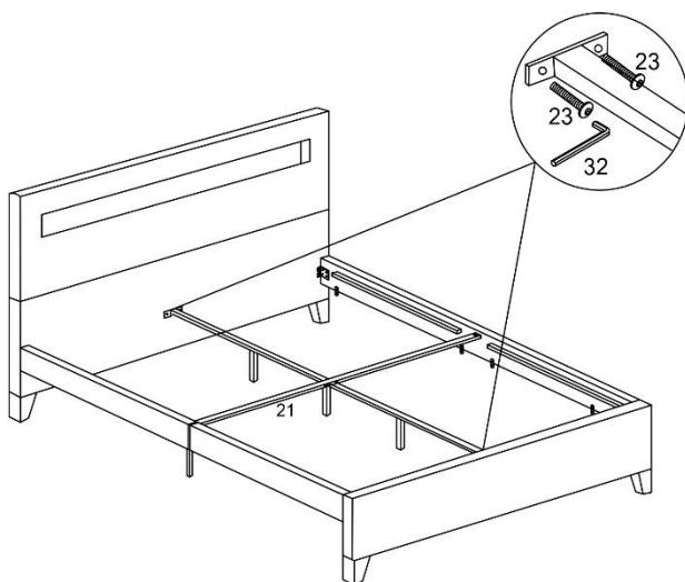
**Schritt 5:** Schraube die Metallleisten (6) an das Kopf- und Fußteil mit den Schrauben (23).
