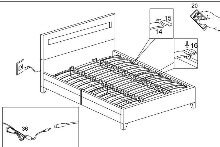
**Schritt 8:** Stecke die Leistenaufnahme (15), (16) auf die äußereren Leisten. Stecke anschließend die Federholzleiste (14) in die Leistenaufnahme.
