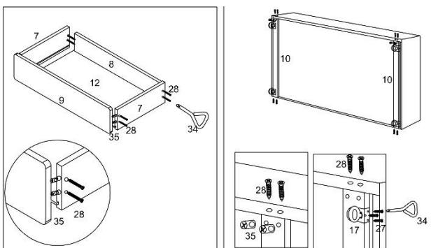
**Schritt 6:** Montiere die Möbelverbinder (35) in den Schubladenseiten. Montiere den Schubkasten mit den Komponenten (7,8,9,12), achte darauf, dass der Schubladenboden (12) in die Nuten der Schubkastenkomponenten (7,8,9) montiert wird. Verschraube alle Komponenten mit den Schrauben (28).
