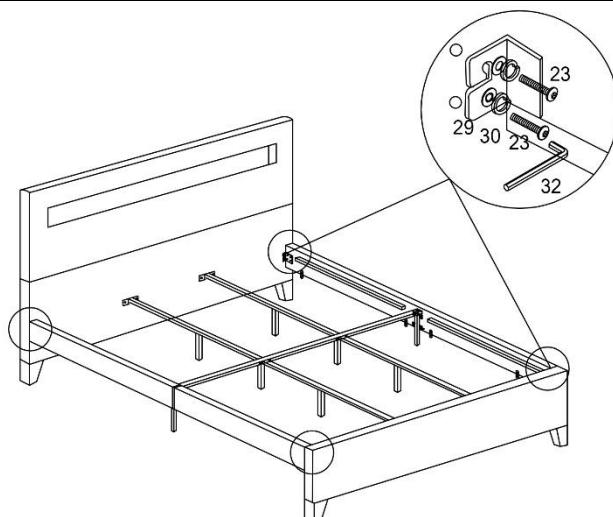
**Schritt 4:** Schraube beide Seitenteile an das Kopfteil mit den Schrauben (23), Federscheibe (30) und den U-Scheiben (29).
