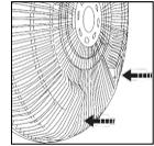
4. Remettez et revissez la bague de blocage de la grille arrière (6) sur le bloc moteur (11) afin de sécuriser l'assemblage de la grille arrière ; tournez dans le sens horaire. Assurez-vous de serrer la bague correctement.
