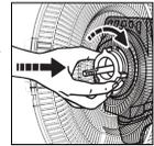
5. Insérez l'hélice (5) sur l'axe du bloc moteur (8) jusqu'à qu'elle se bloque. Placez et serrez l'écrou de blocage de l'hélice (4) ; tournez dans le sens antihoraire. Prenez soin de serrer l'écrou correctement. Vérifiez que l'hélice tourne bien en la tournant manuellement.
