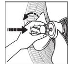
6. Positionnez correctement la grille avant (2) sur la grille arrière (7) en alignant la flèche de la grille avant avec celle de la grille arrière. Assemblez les deux grilles à l'aide des clips de blocage.
