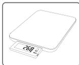
Avant utilisation, placez la balance sur une surface plane, horizontale et dure. Si vous utilisez un récipient, placez-le sur le plateau avant mise en route.
