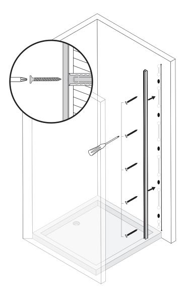
Insérez le panneau de porte (C) dans le profilé mural (A). Pour les verres avec finition semi-opaque et opaque, positionnez la face dépolie à l'extérieur de la douche
