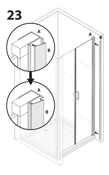
Fixez la baguette de finition en aluminium (élément B) sur le profilé mural (élément A) pour couvrir les raccords et les vis.
