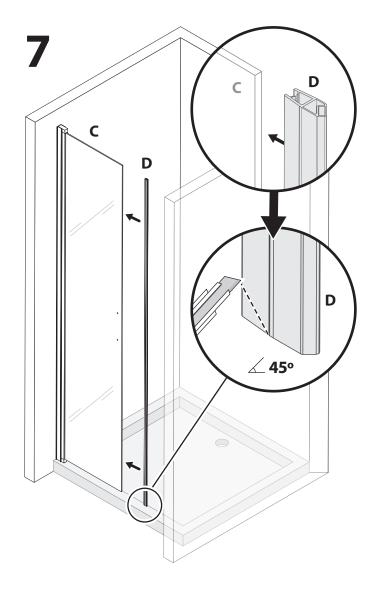
Coupez le joint magnétique (élément D) comme indiqué sur le dessin à un angle de 45 degrés. Insérez ensuite le joint magnétique (élément D) sur la paroi en verre (élément C).
