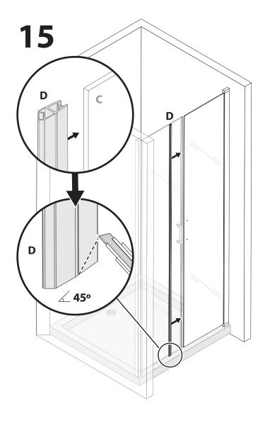
Coupez le joint magnétique (D) à 45 degrés comme indiqué sur le dessin. Insérez ensuite le joint magnétique (D) sur la paroi en verre (C).
