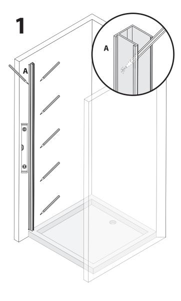
Alignez verticalement le profilé (rail - élément A) sur le mur à l'aide d'un niveau à bulle. Idéalement, le profilé mural doit être au contact du sol / ou du receveur, de sorte qu'il n'y ait pas d'espace excessif en bas. Marquez les points de perçage à prévoir à travers le profilé.
