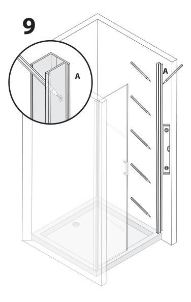
Alignez verticalement le profilé (rail - élément A) sur le mur à l'aide d'un niveau à bulle. Idéalement, le profilé mural doit être au contact du sol / ou du receveur, de sorte qu'il n'y ait pas d'espace excessif en bas. Marquez les points de perçage à prévoir à travers le profilé.
