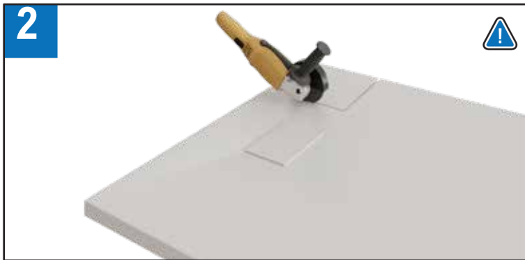
2 Schneiden Sie es mit einer Winkelschleifer- / Gehrungssäge Cut it using an angle grinder / miter saw Córtelo con una amoladora angular / sierra de inglete Coupez-le à l'aide d'une meuleuse d'angle / scie à onglets Tagliatelo utilizzando una smerigliatrice angolare/troncatrice Corte-a usando uma rebarbadora/ serra esquadria
