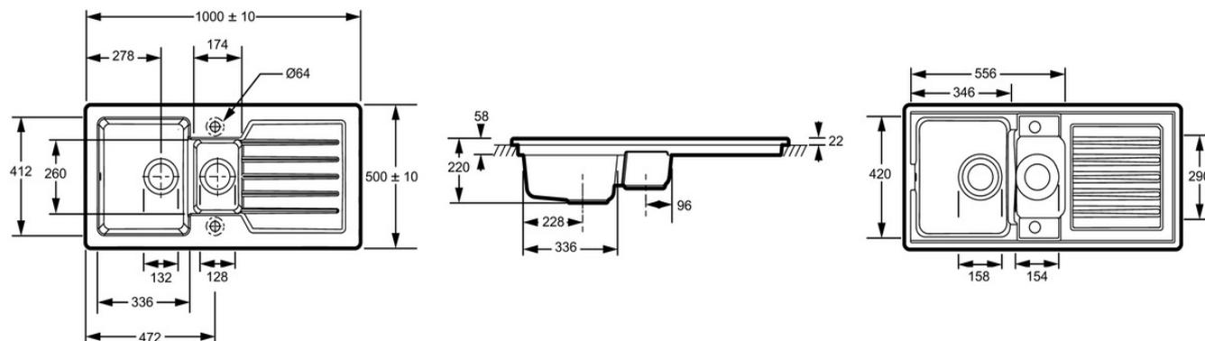
Descriptif CCTP : Evier à encastrer 100 cm, 1 bac et demi. ESC02. Collection : GASPARD. DIMENSIONS : 100 x 50 cm. POIDS : 29,5 kg. MATÉRIAU : Céramique. TYPE D'INSTALLATION : Encastré par-dessus. PERCEMENT ET PRÉ-PERCEMENT ROBINETTERIE : Pré-percé 2 trous. PERCEMENT ROBINETTERIE : oui. TROP-PLEIN : non. NOMBRE DE VASQUES : 1,5 cuves. DURÉE GARANTIE (ANNÉES) : 10. Convient pour un meuble de 60 cm de largeur minimum..
