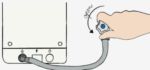
Branchez le tuyau d'arrivée d'eau Bob.easywater d'un côté à l'arrière de Bob et de l'autre sur une arrivée d'eau via un embout fileté de 19 mm (¾ pouce) et **assurez-vous que le branchement soit solidement serré.**
