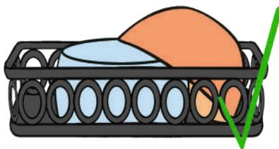
4. Chargez **les articles creux** comme les poêles, les tasses et les verres etc. **ouverture vers le bas et inclinés sur les accessoires du panier de façon à éviter les rétentions d'eau**.
