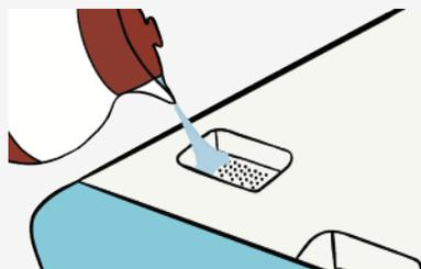
Utilisez Bob de manière autonome grâce à son **réservoir intégré**. Dans ce cas, pas besoin d'arrivée d'eau ! Utilisez la Bob carafe pour remplir le réservoir de Bob en quelques secondes ! Le lave-vaisselle peut être rempli avec de l'eau froide ou chaude jusqu'à 60°C.
