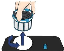
**Tournez le Micro-filtre dans le sens contraire des aiguilles d'une montre** pour déverrouiller l'ensemble Micro-filtre / Filtre gros déchets.
