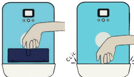
Insérez la cassette jusqu'au clic dans le sens d'insertion avec le texte à l'endroit dans le sens de la lecture.
