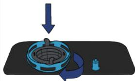
**Remplacez l'ensemble Micro-filtre / Filtre gros déchets** en le tournant dans le **sens des aiguilles d'une montre jusqu'à ce qu'il se verrouille en position.**
