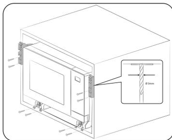
10. Utilisez un foret de 3 mm pour percer les trous dans le meuble afin de fixer les supports de base. Ensuite, fixez à l'aide des vis fournies (type B).
